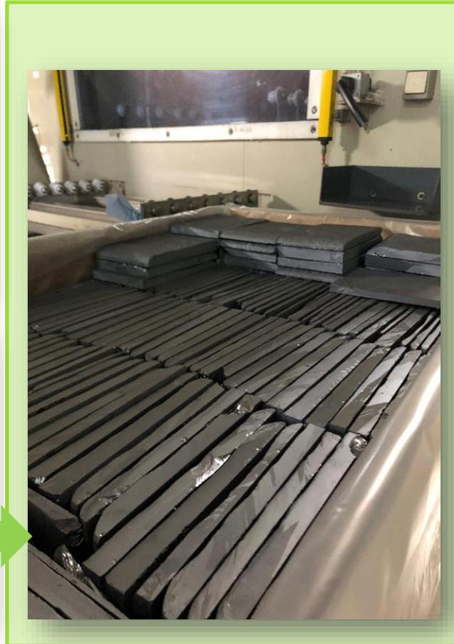
multikristalline Säulen mit Böden (B) und Kappen (K)
